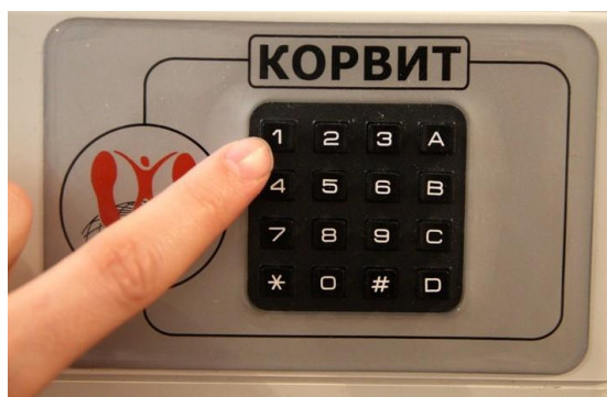
Рис. 6 Выбор режима ходьбы нажатием кнопки клавиатуры кнопки «1, 2, 3» – выбор режима ходьбы; кнопка «#» - ввод;
